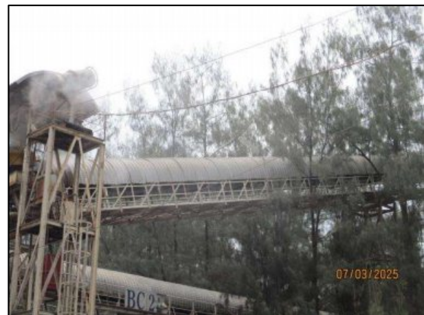
รูปที่ 2-6 การปิดครอบระบบสายพานลำเลียง
