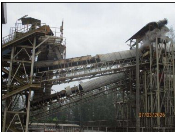
รูปที่ 2-6 การปิดครอบระบบสายพานลำเลียง
