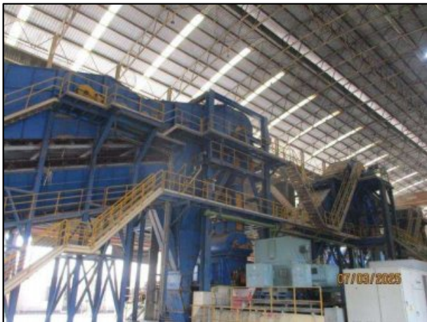
รูปที่ 2-59 อุปกรณ์ปิดครอบเครื่องจักรที่ก่อให้เกิดเสียงดัง
