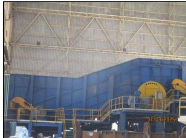
รูปที่ 2-59 อุปกรณ์ปิดครอบเครื่องจักรที่ก่อให้เกิดเสียงดัง
